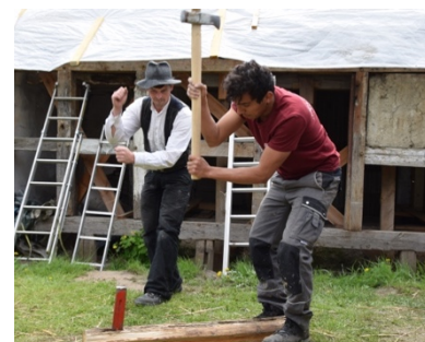
Das Spalten eines Rundholzes zu Staken
