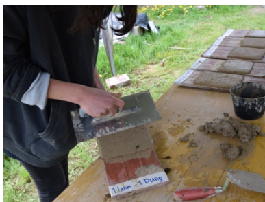
Test zur Entwicklung der Rezeptur eines geeigneten Lehmputzmörtels
